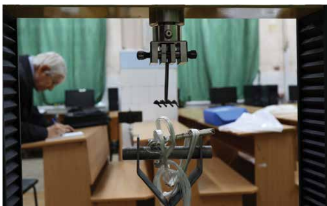
Рис. 10. Момент отрыва имплантата, фиксированного с помощью винтов, установленных под углом 45^\circ Fig. 10. The moment of separation of an implant attached using screws oriented at the 45^\circ angle
