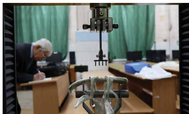
Рис. 11. Момент отрыва имплантата, фиксированного с помощью винтов, установленных под углом 90^\circ Fig. 11. The moment of separation of an implant attached using screws oriented at the 90^\circ angle
