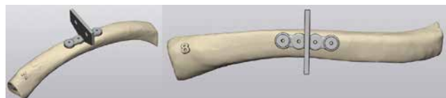
Рис. 2. Образец крепления имплантата с помощью винтов, расположенных под углом 90° к кости
