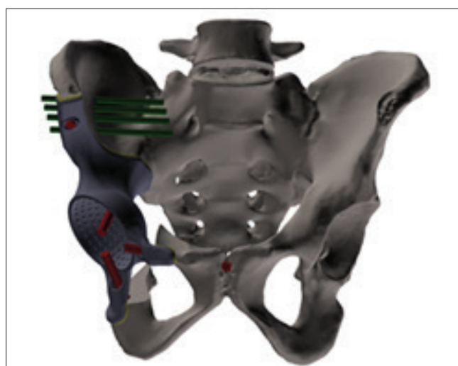
Рис. 3. Компьютерная модель таза и прототип операции, разработанные клиницистами, радиологами и биоинженерами
