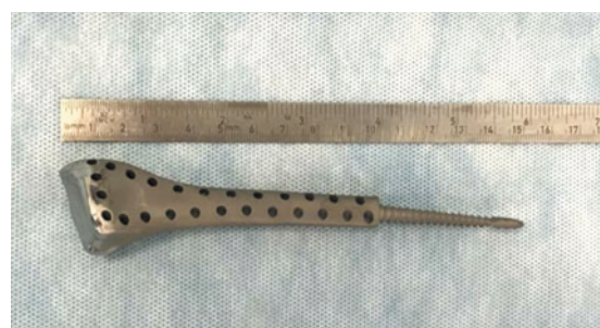
Рис. 8. Эндопротез правой лучевой кости, выполненный из сплава титана методом 3D-печати
