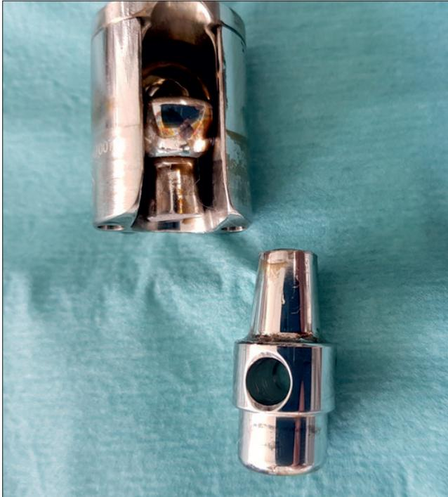
Рис. 3. Поломка элементов эндопротеза
