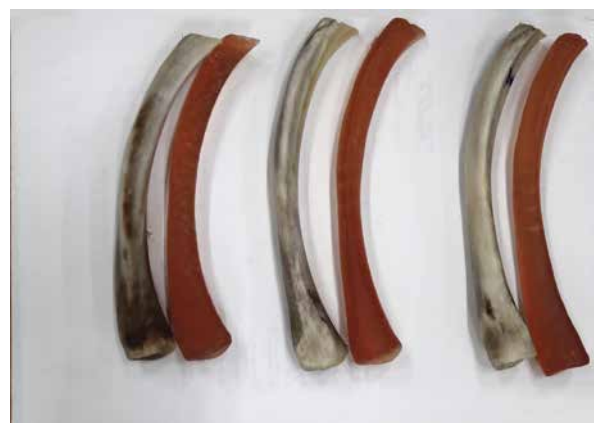
Рис. 8. Свиные ребра и макеты костей, изготовленные из фотополимера
