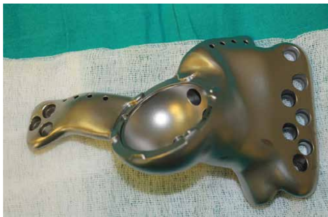
Рис. 6. Имплантат для реконструкции послеоперационного дефекта костей таза, изготовленный на 3D-принтере
