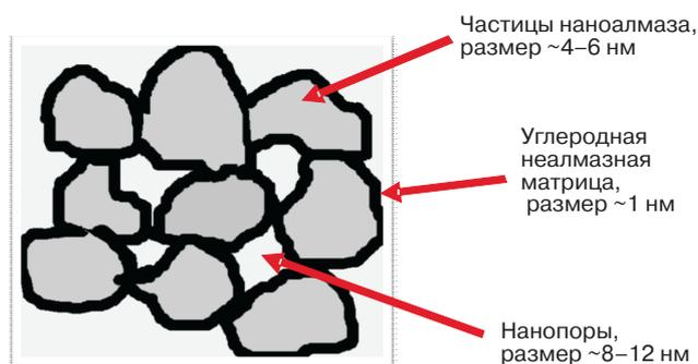
Рис. 1. Структура наноалмазного композита
