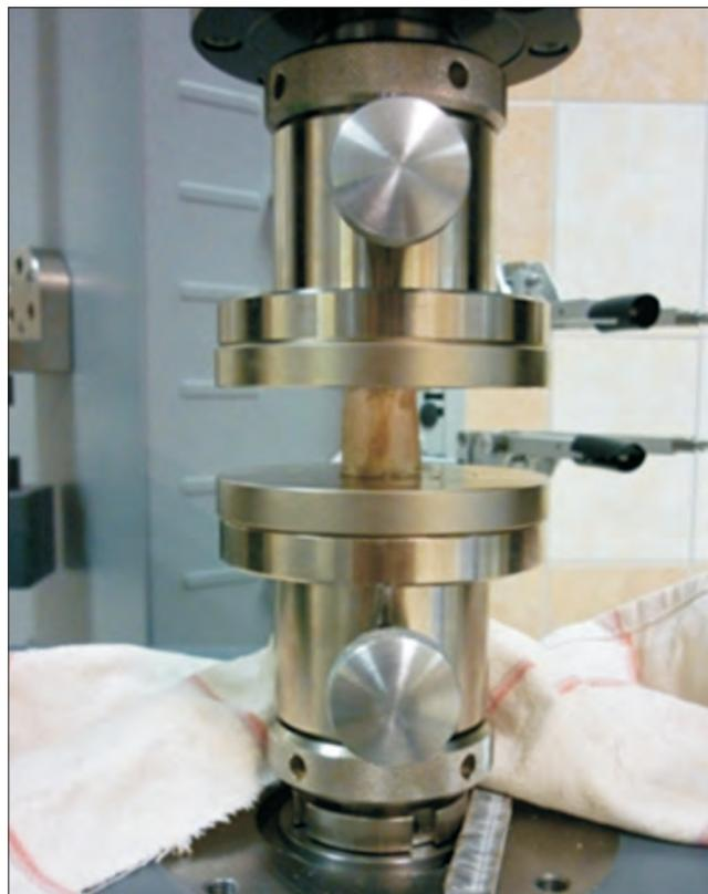
Рис. 2. Рабочая часть универсальной рабочей машины Zwick/Roell с установленным образцом
