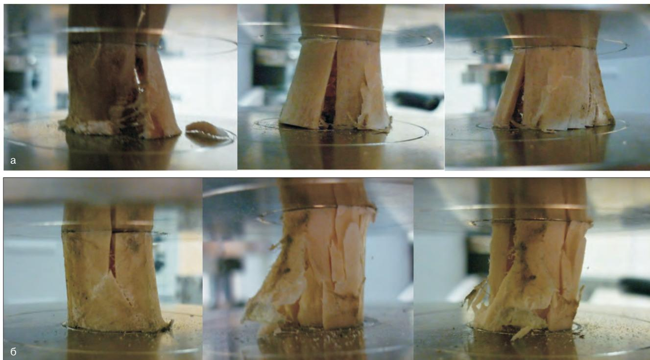
**Рис. 6. Образцы лучевой (а) и плечевой кости (б) после испытаний**
