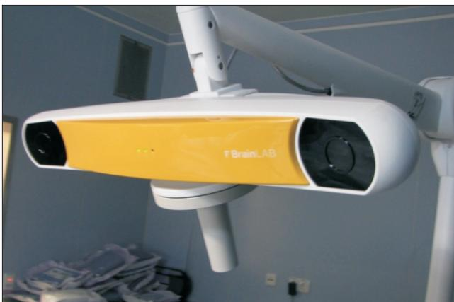
Рис. 3. Камера с инфракрасным излучением
